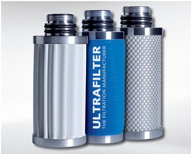
Das Geheimnis liegt in der Plissierung des Filtervlies. So entsteht für die durchströmende Druckluft eine Filterfläche, die um 450% größer ist als bei einem konventionell gewickelten Filterelement. Ihre Nutzen liegen klar auf der Hand:
